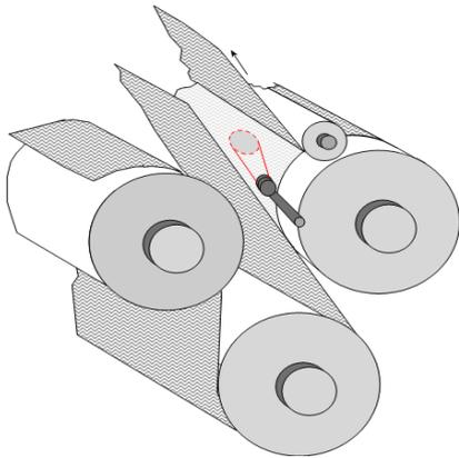
SensoWeb „Slalom“ wird am Ende einer Trockengruppe installiert, wo das Papier das Sieb verlässt und kurz am blanken Stahlzylinder läuft.
